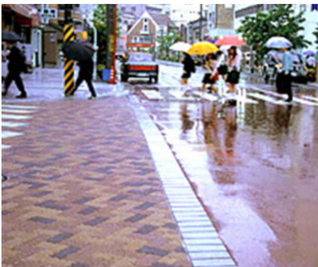
투수블록 포장(좌), 불투수 아스팔트 포장(우)
