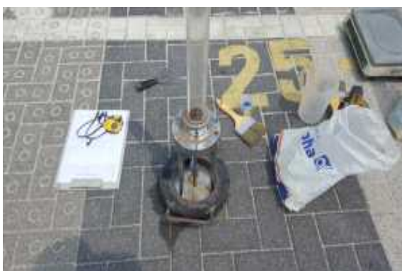
현장 투수량 시험 전경
