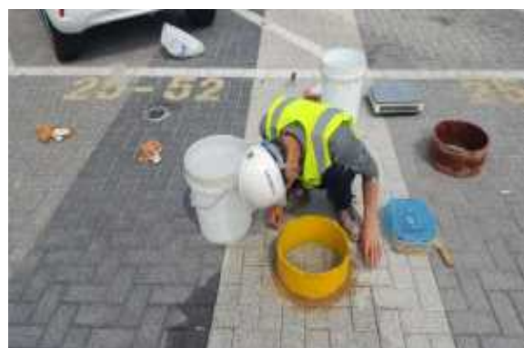
현장 침투능 시험 전경
