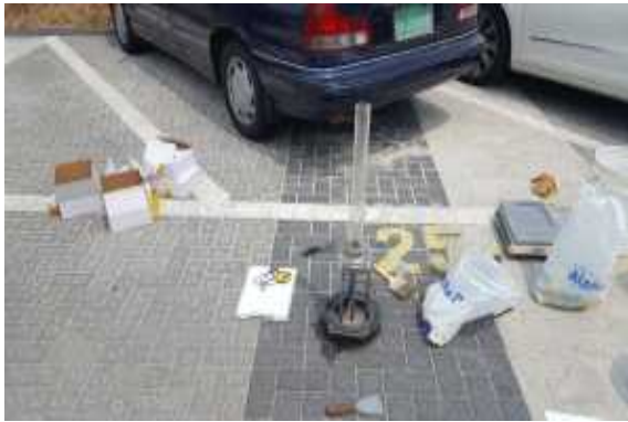
현장 투수량 시험 전경
