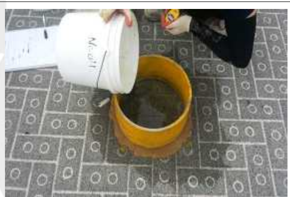
현장 침투능 시험 전경
