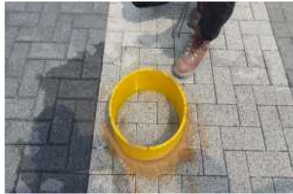
현장 침투능 시험 전경
