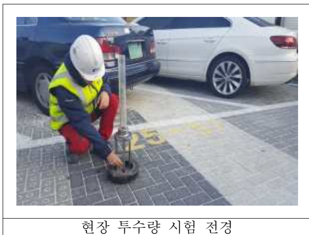
현장 투수량 시험 전경
