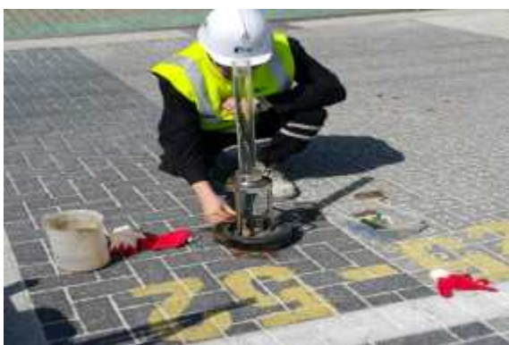
현장 투수량 시험 전경
