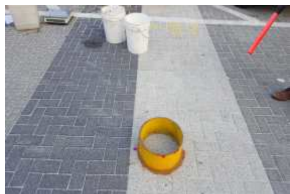
현장 침투능 시험 전경
