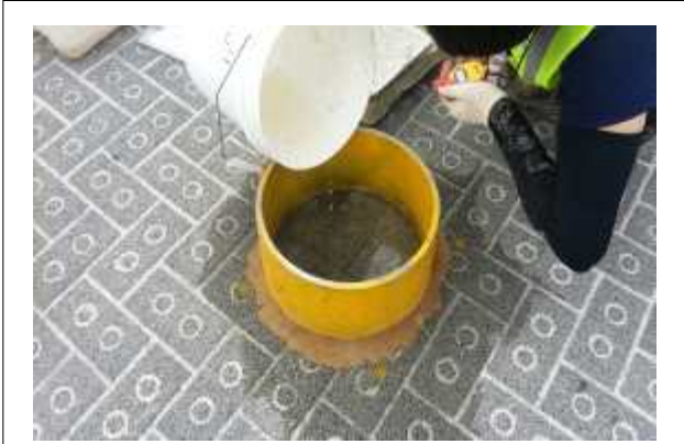
현장 침투능 시험 전경
