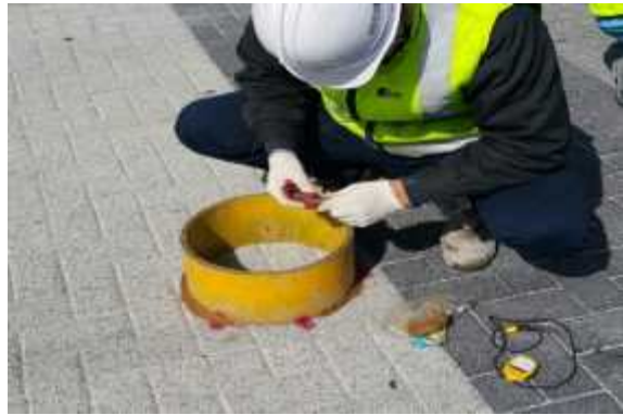
현장 침투능 시험 전경
